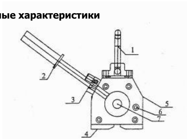
Рисунок 1. Сборочные детали магнитного захвата
